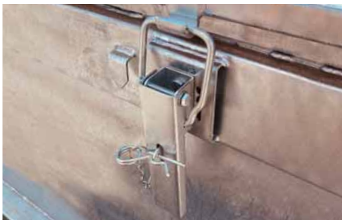
Zamek pokrywy - zamknięty i zabezpieczony
